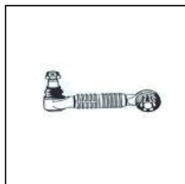
Barra Estabilizadora Codigo: A6343260516 Bieleta estab. trasera izq. O500 / Largo: 300 mm.
